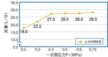
【流量測定(二次側圧力を0.3MPaに設定)】
