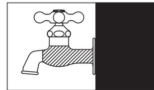
蛇口内部の常に水が溜まっている部分を重点的に、蛇口マフラーを巻きます。(斜線部分)
