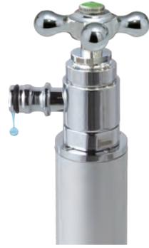
MIZSEI の凍結防止水栓は「SMA(形状記憶合金)バネ」を搭載。本体が凍結しそうな温度(約2.0℃以下)になると、弁が自動的に開き、少量の水(約450ml/min)を通水して凍結を防止します。
