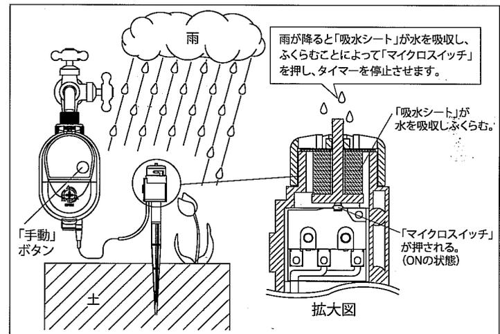
●雨が止んでも「吸水シート」が濡れている限り「マイクロスイッチ」を押しているため「吸水シート」が乾燥するまでタイマーは作動しません。（自動水やり設定した散水をキャンセルします。）
