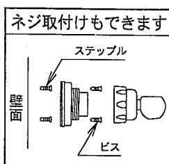
壁面(タイルの目地等)に穴を開け、ステップルを打ち込み、吸盤の上からのネジ止めも出来ます。
