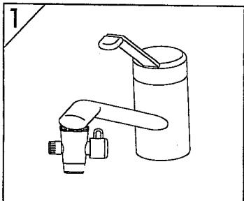
付属の「マルチコックアダプター セット」の取付け方法をご参考に、ご使用の水栓に合ったアダプターを使い、マルチコックを接続します。
