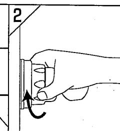
壁面に強く押し付けながらグリップ部を強く締付けて下さい。
