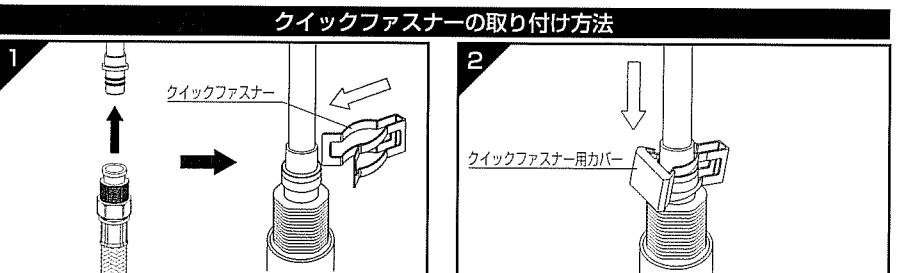
専用水栓の接続部とブレードフレキ管を取り付け、クイックファスナーで固定します。
