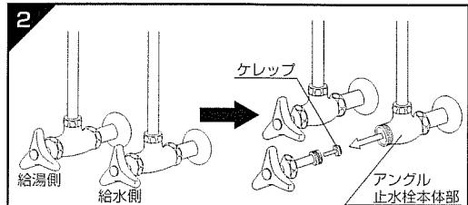
既設の給水側角度止水栓のハンドル上部ナットを左に回して取り外します。
