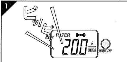
流量計の「残りの使用量」が200ℓを下回った場合、アラーム音が3回鳴り「FILTER」マークが点滅します。
