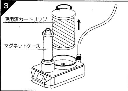
架台から使用済カートリッジを左に回して取り外して下さい。
