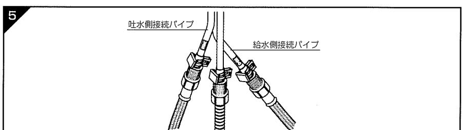
吐水側・給水側のブレードフレキ管を専用水栓の吐水側接続パイプ（↑）と給水側接続パイプ（↓）に押し込み、クイックファスナー（詳細は9ページ）で接続します。
