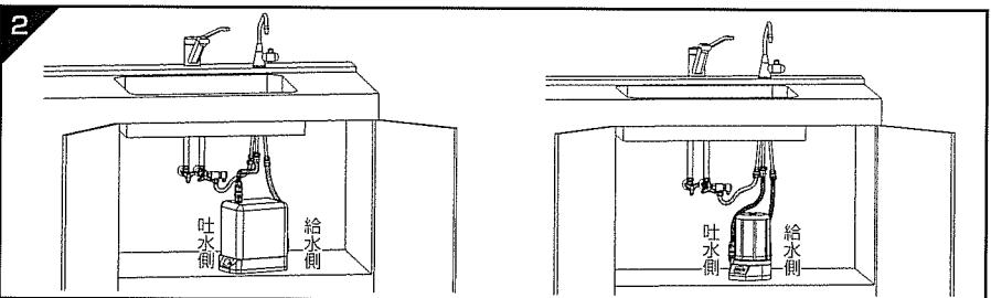
給水側ブレードフレキ管を上図のように本体の給水側に、吐水側ブレードフレキ管を本体の吐水側にそれぞれカプラで接続します。
