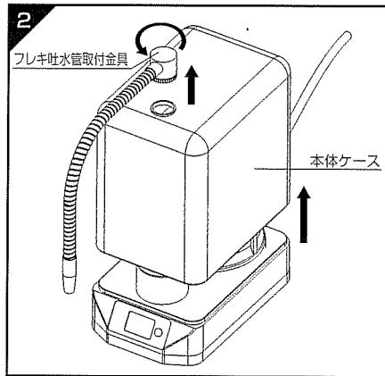
本体上部のフレキ吐水管取付金具を左に回して取り外し、本体ケースを取り外します。
