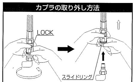
LOCKを外し、カブラの先端部のスライドリングを引き下げます
