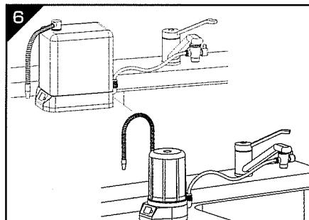
取付後、各部がしっかりと接続、固定されているかを確認の上、通水して下さい。
