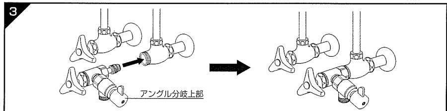
角度止水栓本体部に付属の角度分岐上部（固定ケレップ付）のナットを右に回して締め付けて下さい。
