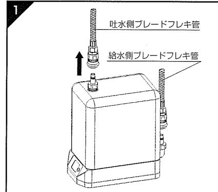
アンダーフラッシュ上部を開め、給水側・吐水側ブレードフレキ管を本体から取り外し、本体を流し台等の水が漏れても差し支えのない所へ持っていきます。
