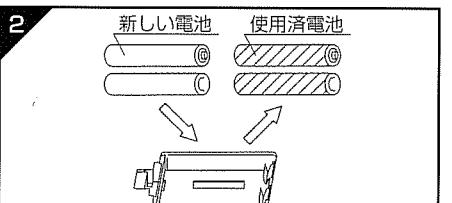
使用済乾電池と新しい乾電池を交換します。
