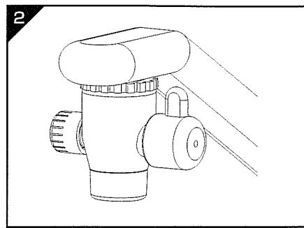
付属の切替コックアダプターセットの取り付け方法(アダプターセット梱包物の裏面)を参考に、ご使用の水栓に合ったアダプターを使い、切替コックを接続します。
