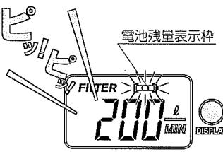
乾電池の残量が0になると、「電池残量表示」枠を点滅させ連続5回のアラーム音が鳴ります。
