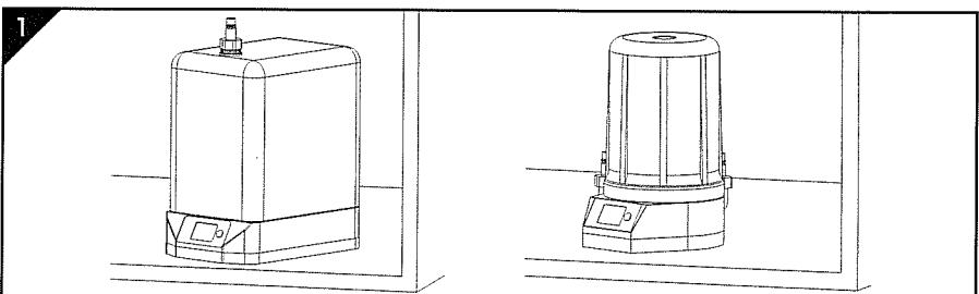
400mmのブレードフレキ管が接続可能で極端に折れ曲がらない場所へ『磨水Ⅱ』『磨水ⅡS』本体を設置します。
