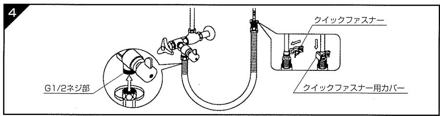
レバーハンドルのG1/2ネジ部に給水用フレキシブル管を右に回して取り付けて下さい。
