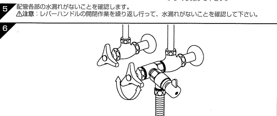
5 配管各部の水漏れがないことを確認します。
