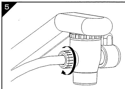
給水ホースを切替コックに差し込み、ホース止めナットで水漏れがないように強く締め付けます。
