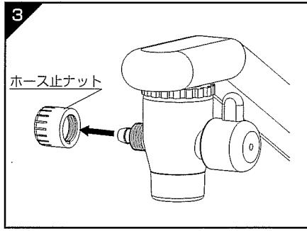
切替コックからホース止ナットを外して下さい。
