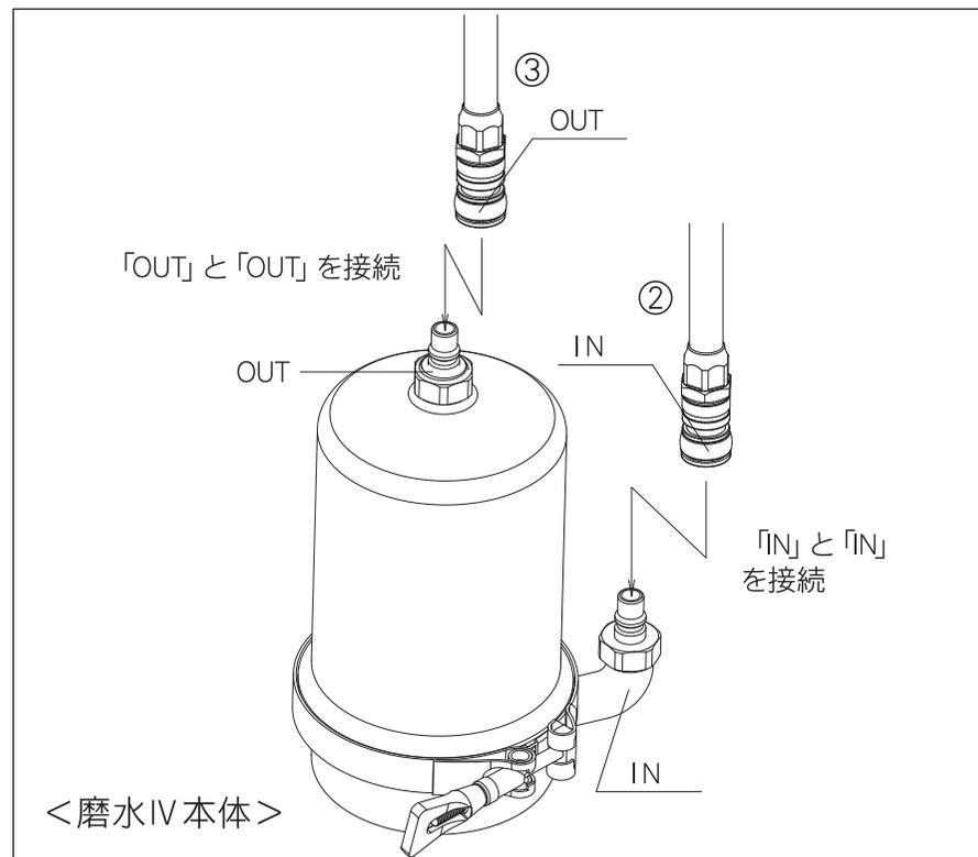
②の配管用ホース(カプラ付き)は「IN」用カプラと、③は「OUT」用カプラと接続して下さい。「OUT」用カプラと本体「OUT」部、「IN」用カプラと本体「IN」部をそれぞれ接続して下さい。
