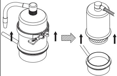
**4** 本体カバーから使用済カートリッジを矢印の方向へ回して取外した後、新しいカートリッジを取付けて下さい。
