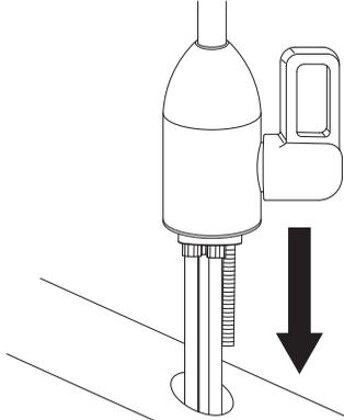
**4** シンクの下から馬蹄金具、締付けナットを取付けて下さい。
