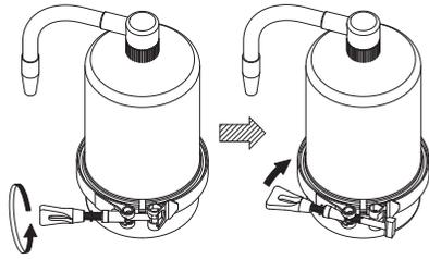
**3** 締め付けバンドを外した後、本体カバーを外して下さい。
