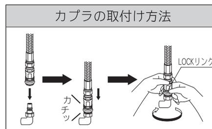
カプラノズルにカプラを「カチッ」と音がするまで差し込み、LOCKリングを矢印の方向へ回してLOCKします。
