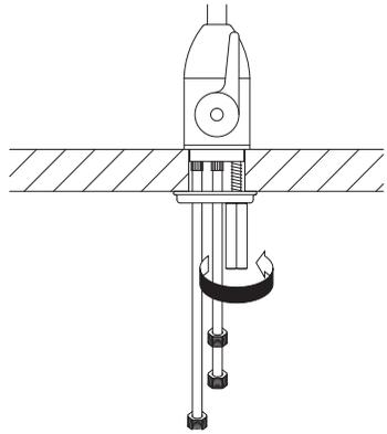
**6** 専用水栓を固定後、レバーハンドルを止水位置にして下さい。
