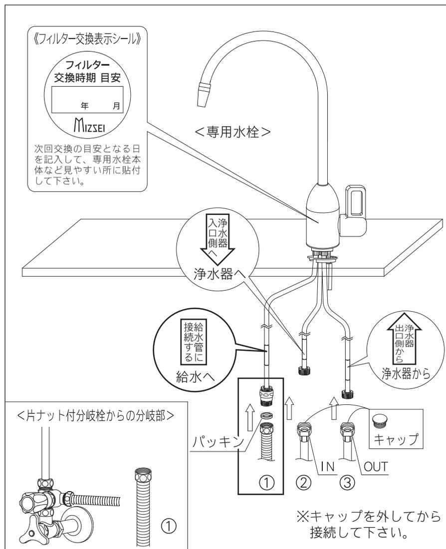
上図の様にホームチューブ、配管用ホースを浄水器専用水栓に接続します。片ナット付分岐栓からは①、浄水器本体からは②、③にそれぞれ接続して下さい。
