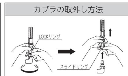
LOCKリングを矢印の方向へ回してLOCKを外し、カプラの先端部のスライドリングを引き下げます。
