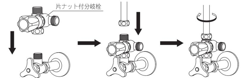
**4** ホームチューブに付属のパッキンを入れ、片ナット分岐栓のもうひとつのネジ部にホームチューブのナットを矢印の方向へ回して取付けて下さい。
