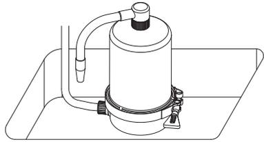
**2** 締め付けバンドの蝶ハンドルを矢印の方向へ回して緩めた後、奥に引いて、T型ボルトを外して下さい。
