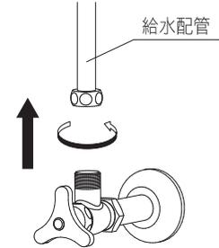
**3** 給水配管を取り外したところに現れるネジに、片ナット分岐栓を取付けて下さい。さらに、片ナット分岐栓に先程取り外した給水配管を再び取付けます。(片ナット分岐栓・給水配管のナットを矢印の方向に回して取付けます。)
