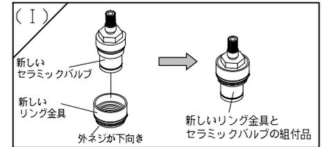
(II) 「リング金具とセラミックバルブ組付品」を矢印の方向に「水栓本体」に組付けます。
