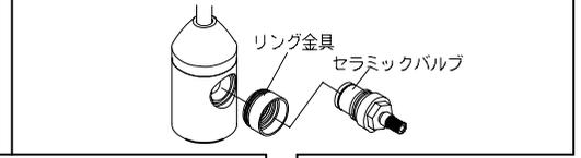
⑤「新しいセラミックバルブ」(品番: JF-V)を差し込み、「モンキーレンチ」で矢印の方向へ締め付け固定します。
