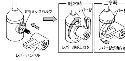
⑦「レバーハンドル」の「固定ビス」を「プラスドライバー」で固定後、「ハンドルキャップ」を取付けます。
