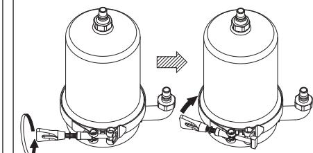
**4** 架台から使用済カートリッジを矢印の方向へ回して取外した後、新しいカートリッジを取付けて下さい。
