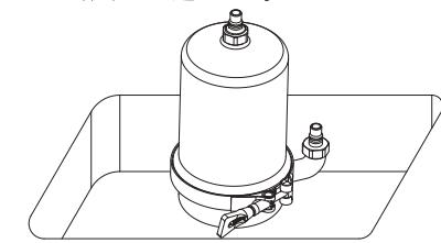
**3** 締付けバンドを外した後、本体カバーを外して下さい。
