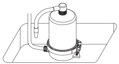
**2** 締付けバンドの蝶ハンドルを矢印の方向へ回して緩めた後、奥に引いて、T型ボルトを外して下さい。
