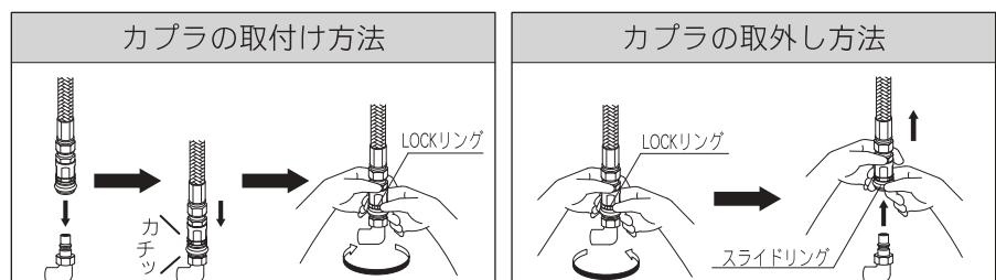
カプラノズルにカプラを「カチッ」と音がするまで差し込み、LOCKリングを矢印の方向へ回してLOCKします。
