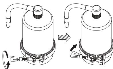
**3** 締付けバンドを外した後、本体カバーを外して下さい。
