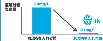
試験方法/超純水1Lに次亜塩素酸ナトリウムを加し、遊離残留塩素3.0mg/Lに調整。その後
