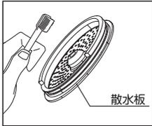
③散水板の周りにある水垢や汚れた部分をブラシで掃除をします。汚れがひどい場合等、必要に応じて、重曹を用いて洗浄してください。
