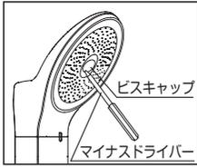
①ビスキャップの溝にマイナスドライバーを差し、手前に引き上げ、ビスキャップを外します。プラスドライバーを用いて内部のビスを外します。※部品を紛失しないよう注意してください。
