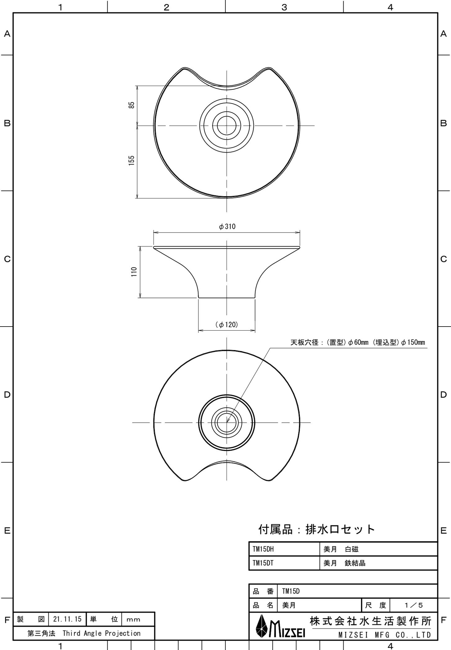
天板穴径：(置型)  $\phi 60\text{mm}$  (埋込型)  $\phi 150\text{mm}$
