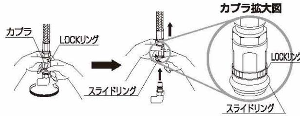
**2** 左記の「カウンター据置タイプ」の手順1〜5と同様の手順でカートリッジを交換して下さい。
